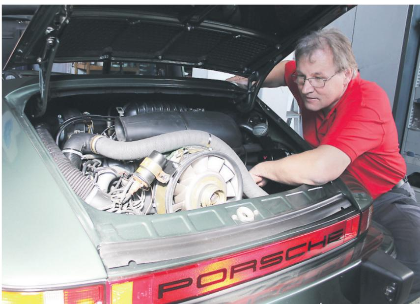
Typisch für den 911er: Der luftgekühlte Boxermotor befindet sich ganz hinten im Heck.
